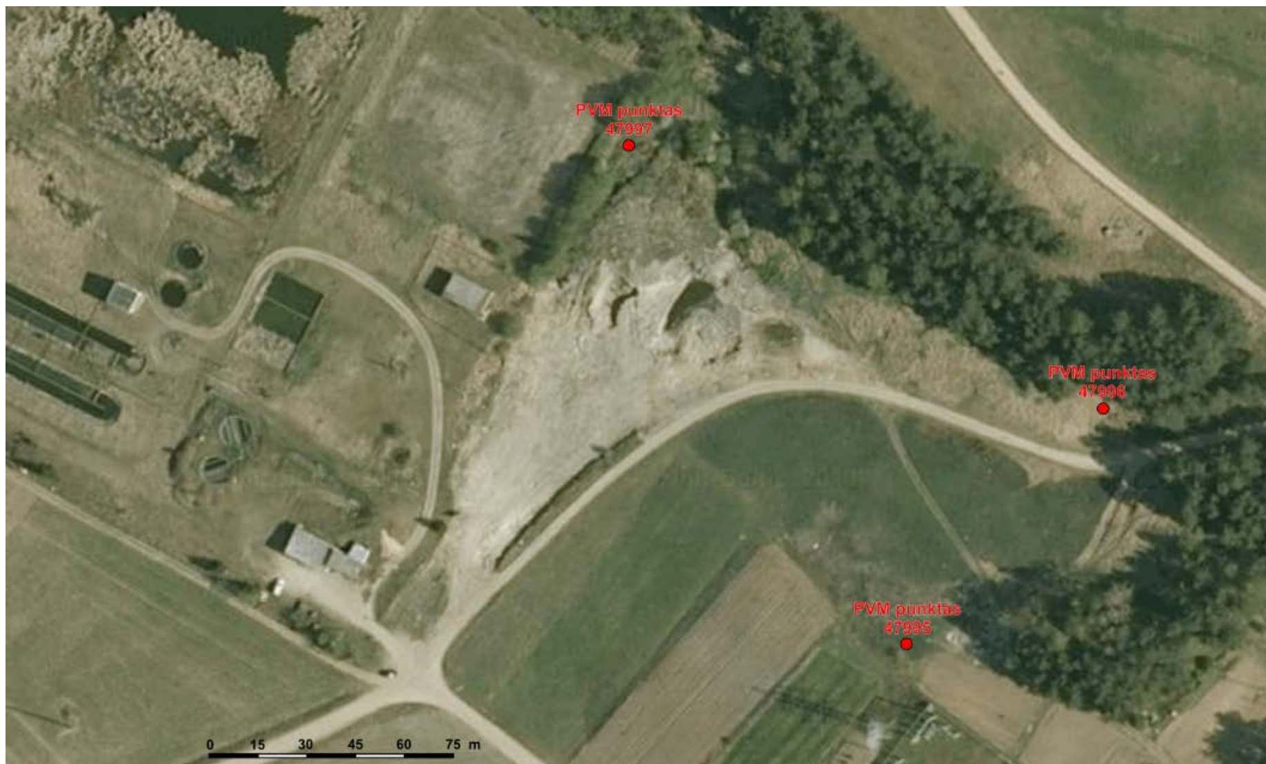
4.1 pav. Matuizų sąvartyno monitoringo tinklo schema (šaltinis: UAB „DGE“ 2014 metų aplinkos monitoringo ataskaita)
