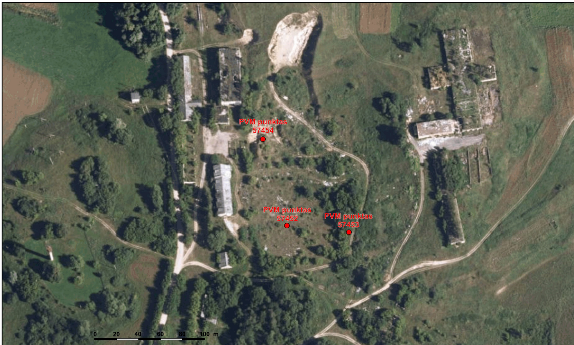
Požeminio vandens monitoringo postų schema
