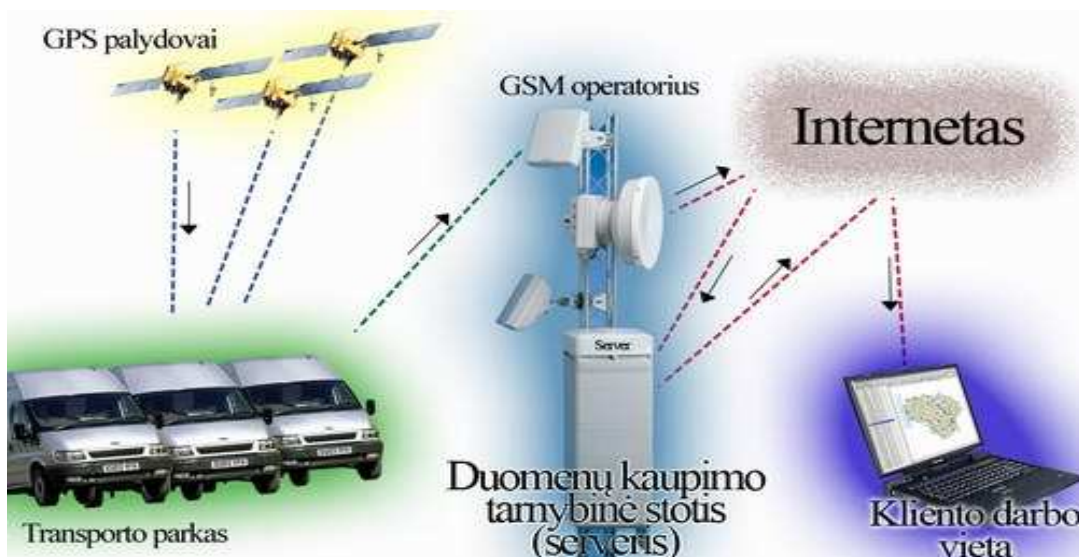
21 pav. Transporto kontrolės ir valdymo sistemos veikimo principas.
