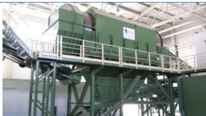
29 pav. Mechaninio rūšiavimo įrenginiai veikia be rankinio rūšiavimo ir yra visiškai automatizuoti
