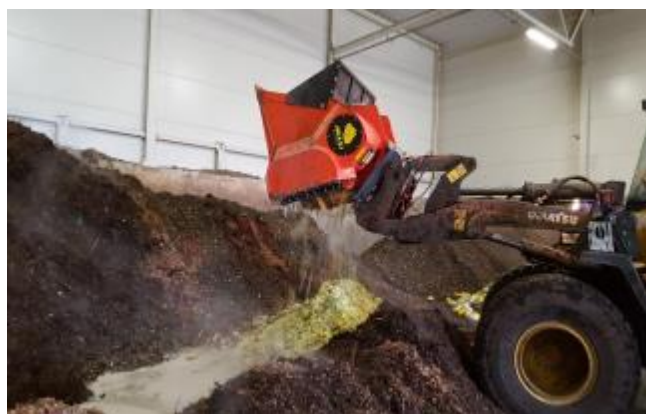
31 pav. Smulkinamos, maišomos ir ruošiamos biologinės atliekos apdorojimui
