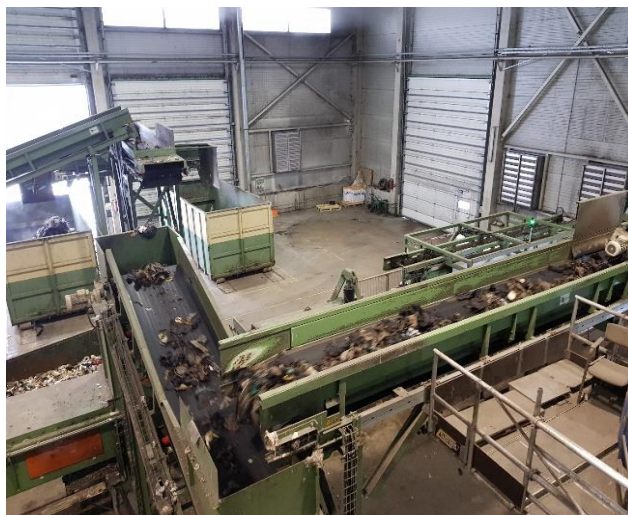
38 pav. Rūšiavimo įrenginiais atskiriama įvairi pakuotė ir antrinės žaliavos
