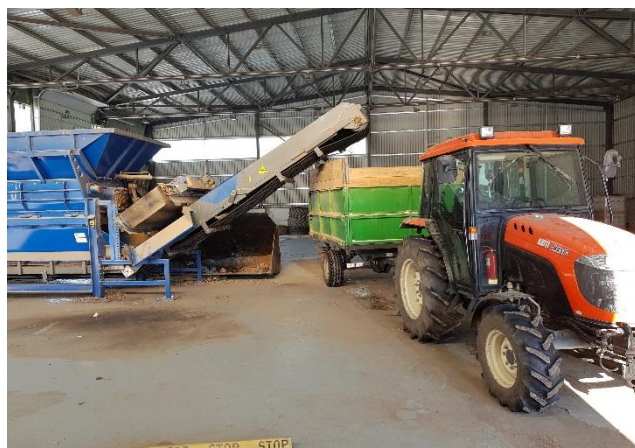
21 pav. Vyksta intensyvūs medienos smulkinimo darbai, iš baldų bus pagaminta žaliava drožlių plokštei gaminti, iš kelmų struktūrinė medžiaga kompostui
